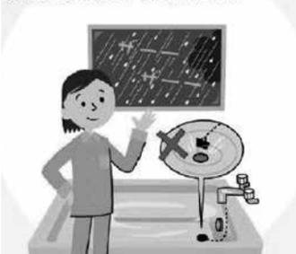
新たに下水道に接続する時には、家庭の浄化槽を雨水貯留浸透施設へ転用しましょう。
