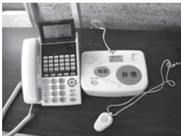
緊急通報システム
