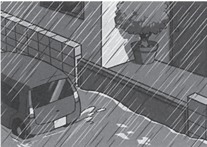
浸水防止施設の一例「浸水防止版」
